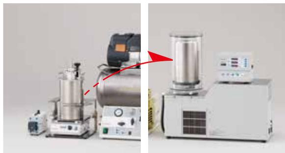
噴霧凍結後、真空断熱容器を凍結乾燥機のドライチャンバーに直接設置できるので、容器の入替えなどの作業がなく一連の乾燥工程が容易に行なえます。
