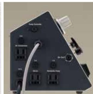
電源操作ボックスに操作部・電源関係が集約しているので、操作・セッティングが容易です。また、送液量や噴霧圧を調整することで、粒子径のコントロールも可能です。
