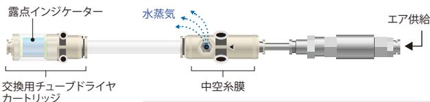
構成品：チューブドライヤ、ニップル、減圧弁、メスストレート・ストレート(piscoの継手)、減圧弁
