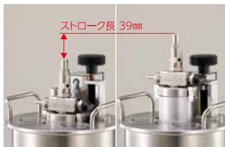
スプレーノズル(二流体ノズル)の高さ位置をノボルトで調整(PAT.P)でき、回収率と粒径の調節が可能です。高さ位置調節用に目盛りが付いているので、再現性の高い実験が行なえます。蓋上部の排気ノズルを利用することで、窒素ガスを一括で排気できるので、ドラフトチャンバー外での操作も行なえます。
